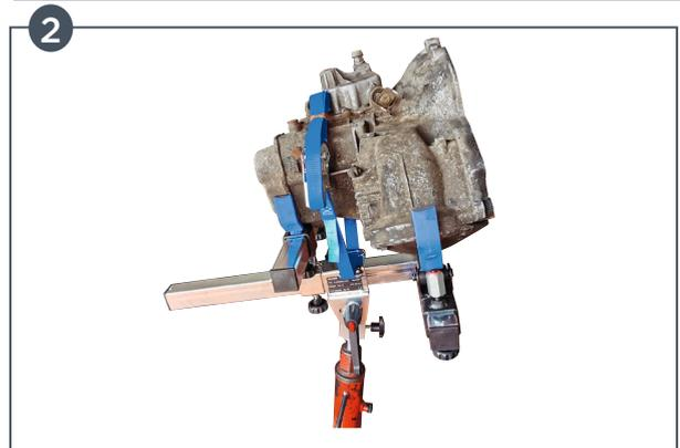
**7** - Déplacez les traverses arrière vers la poutre centrale en fonction de la longueur de la boîte de vitesses. Fixez les bras avant et arrière contre la boîte de vitesses.
