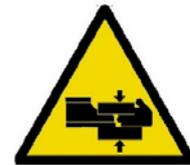
Interdiction de placer des parties du corps entre les fourches et le sol ou entre les fourches et les appuis de base de l'élévateur
