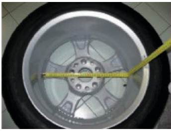
Figure F3.3.1. Exemple de prise de mesure du diamètre externe "da2" pour les programmes ALS1/ALS2
